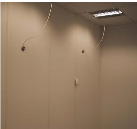
Fig. 5. Placering af en lyssensor på sidevæggen i Sbi's dagslyslaboratorium, hvor det beregnede og målte sted opfylder kravet K = D , og hvor man opnåede en ideel regulering. Lyssensoren sidder på sidevæggen nær lyspletten fra kunstlyset,
